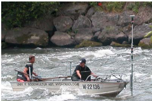
Abb.3: Messboot mit GPS-, TPS- und Echolotsensoren
